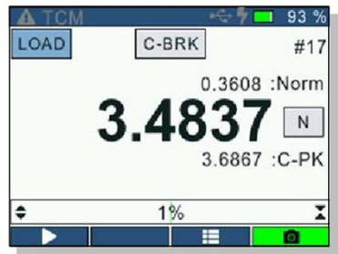
Écran de résultat en direct avec numéro d'analyse, indicateur réussite/échec, unités et mode d'affichage.
