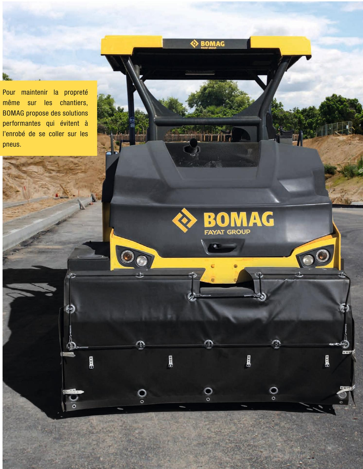
Pour maintenir la propreté même sur les chantiers, BOMAG propose des solutions performantes qui évitent à l'enrobé de se coller sur les pneus.
