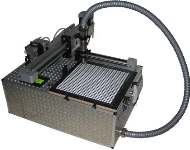
**Le principe de la méthode** est la spectroscopie proche infrarouge ; elle repose sur l'absorption du rayonnement proche IR par la matière organique. Une lumière infrarouge est envoyée sur les échantillons de plastiques et la lumière réfléchie est analysée en utilisant une rangée de détecteur.
