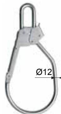
5266AZ025 acier zingué GRANDE OUVERTURE verrouillage automatique double-action ouverture 83mm 330 x 155mm, 820 gr. Résistance 20kN (2039kg)
