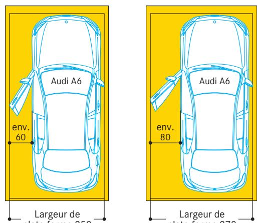
L'espace d'ouverture des portes varie en fonction du modèle de véhicule et de la position de stationnement du véhicule sur la plate-forme. Pour des conditions confortables pour monter et descendre du véhicule, nous recommandons des largeurs de plate-forme à partir de 270 cm.
