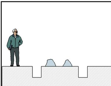
**01** - Marquez l'emplacement de votre future clôture. A l'emplacement des deux premiers poteaux, creusez un trou de 40x40cm sur 50 cm de profondeur minimum (la profondeur varie en fonction de la hauteur hors sol de la clôture, de la nature du sol et de la force des vents).
