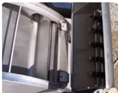
Rampe réversible ouverte pour un accès simple et rapide aux buses.
