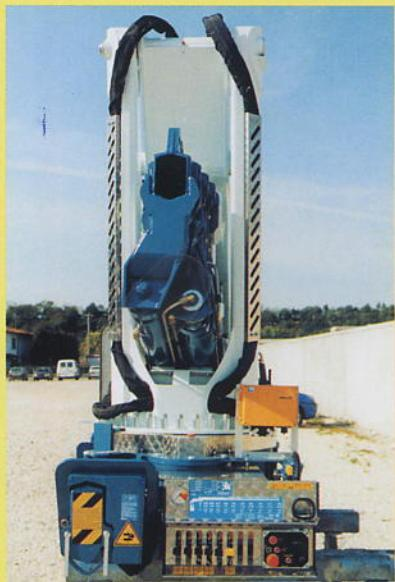
· Compattezza: 20 m di braccio idraulico 27 t\*m di capacità' in uno spazio di 1x2.5x2.2 m
