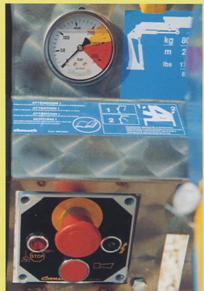
· Indicatore dello stato di carico con evidenziate le zone di preallarme e allarme come richiesto dalle normative internazionali.
