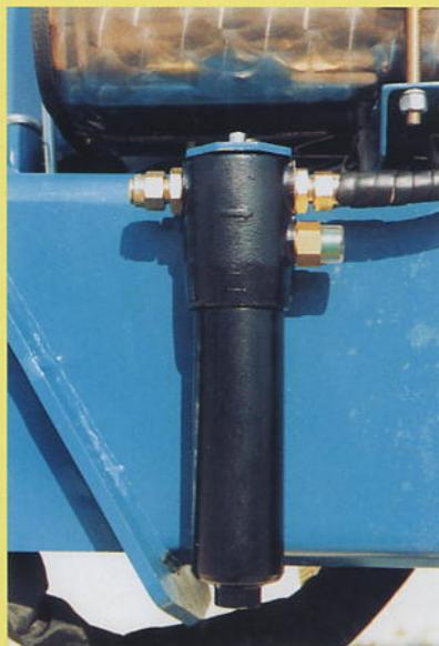
· Filtro ad alta pressione con spia luminosa di intasamento sul pannello di controllo.
