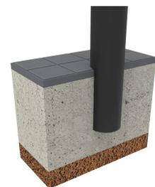
Ancrage recommandé : encastrement au sol.
