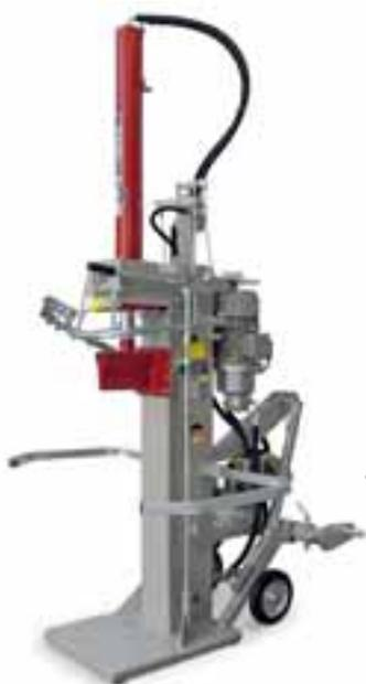
USP 16 HZE/1 modèle combiné avec système hydraulique intégré, l'entraînement est fait par prise de force du tracteur et arbre cardan et par moteur électrique 5,5 kW
