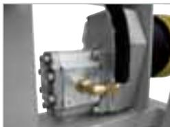
La vitesse du vérin est déterminée par des pompes hydrauliques surdimensionnées.
