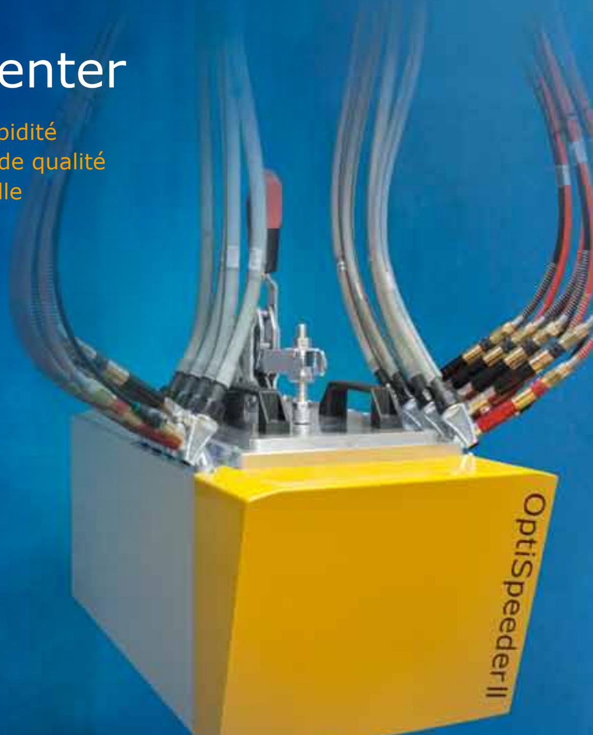
OptiCenter est le nom d'une nouvelle génération de systèmes de gestion de la poudre. Le travail a lieu rapidement et sans formation de poussière, le revêtement obtenu est de remarquable qualité. L'OptiCenter est un concept nouveau, modulaire, qui peut être mis en œuvre aussi bien de manière autonome qu'en étant intégré avec la commande des pistolets, des axes et de la cabine.
