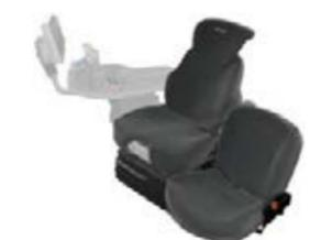
■ Le siège confort est à suspension pneumatique et le réglage de l'accoudoir est d'une simplicité enfantine.
