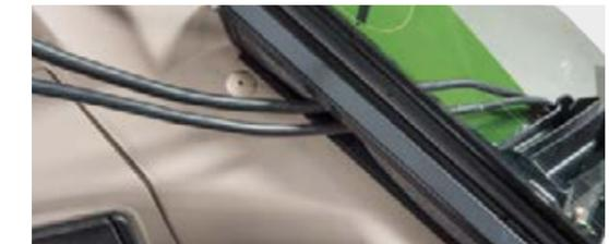
■ Fendt propose une solution intelligente pour les câbles en provenance de l'arrière du tracteur qui pénètrent dans la cabine. Les câbles peuvent être acheminés par le passe-câbles, quelle que soit leur section. Le conducteur peut fermer la vitre arrière pour empêcher la poussière, les impuretés, l'eau et le bruit de pénétrer à l'intérieur.
