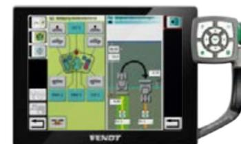
Les fonctions pour la commande d'outils Variotronic<sup>TI</sup> (ISOBUS) et la gestion de fourrières peuvent être assignées au levier multifonction, selon les besoins. En combinaison avec le système d'autoguidage VarioGuide, le Variotronic<sup>TI</sup> automatique permet d'activer automatiquement les séquences de manœuvres en bout de champ.
