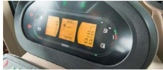
■ L'éclairage intérieur est conçu pour illuminer les zones importantes de la cabine. De jour comme de nuit, les principaux éléments de commande sont agréablement rétroéclairés. L'intensité lumineuse est contrôlée automatiquement par un capteur en fonction des conditions d'éclairage.
