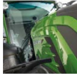
□ Le pare-brise collé en verre trempé résistant à la torsion est monté de série. Pour augmenter encore le confort et la sécurité, un pare-brise chauffant en verre feuilleté est également disponible.
