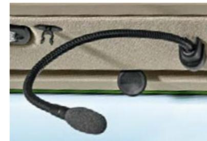
Le téléphone mains-libres permet des conversations avec une excellente qualité audio grâce au microphone flexible et orientable.
