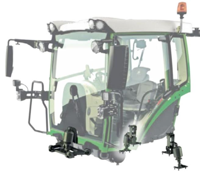
■ La suspension pneumatique 3 points supprime les oscillations en cabine. La différence de hauteur entre les éléments de suspension de la cabine X5 empêche en outre le tangage, assurant ainsi un maximum de confort.
