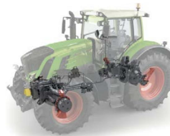
Le système de télégonflage intégré VarioGrip adapte la pression des pneus en un temps extrêmement court – même pendant la conduite. Ceci est réalisé via un joint tournant intégré, conçu pour résister toute la durée de vie du tracteur. L'alimentation en air est assurée par un double compresseur à refroidissement liquide ainsi que par des valves propres au tracteur.
