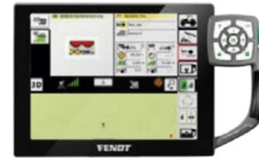
Le système VarioDoc permet de transférer sans fil les données entre le terminal Vario et le logiciel de gestion parcellaire du PC. Le dispositif VarioDoc Pro enregistre en continu la position et les données de la machine ; le transfert de ces données est ensuite possible par le biais d'un réseau mobile.
