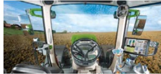
Le Fendt 900 Vario a été perfectionné pour que la visibilité soit optimale. Le capot a été conçu de manière à ce qu'il reste le plus étroit possible pour que le conducteur ait une vue excellente sur les passages de roue et les outils montés à l'avant.
