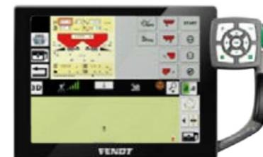
La commande Variotronic™ pour outils (ISOBUS) est entièrement intégrée dans le terminal Vario 7™ et dans le terminal Vario 10.4™. L'outil est commandé par le terminal et le joystick, un terminal supplémentaire n'est donc pas nécessaire.
