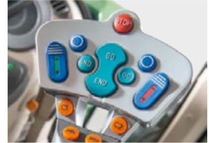
Joystick multifonction avec commandes de 2 distributeurs, touches d'activation des Tempomat et de mémorisation du régime moteur ainsi que pour l'activation du système de gestion des fourrières Variotronic<sup>TI</sup>. Jusqu'à 10 fonctions ISOBUS peuvent lui être attribuées.
