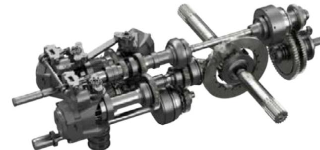
La transmission Fendt Vario est un entraînement mécanique-hydrostatique à puissance partagée. Au fur et à mesure que la vitesse augmente, la part de puissance mécanique transmise à travers le train épicycloïdal augmente. L'excellent degré d'efficacité est assuré par les pompes hydrauliques pivotant à 45° et par la pression de service élevée de 550 bars maximum.
