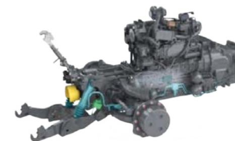
Le report de charge est disponible en option sur le Fendt 900 Vario pour le relevage avant confort. Il permet de transférer une partie du poids de l'outil sur le tracteur. Cette solution est particulièrement utile pour travailler avec une faucheuse frontale ou des outils d'entretien en hiver, parce qu'elle réduit la charge sur l'outil et améliore la maniabilité. La pression de décharge peut être réglée sur le terminal Vario.
