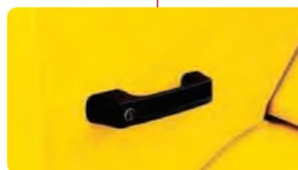
Système de verrouillage de recouvrement d'aile
