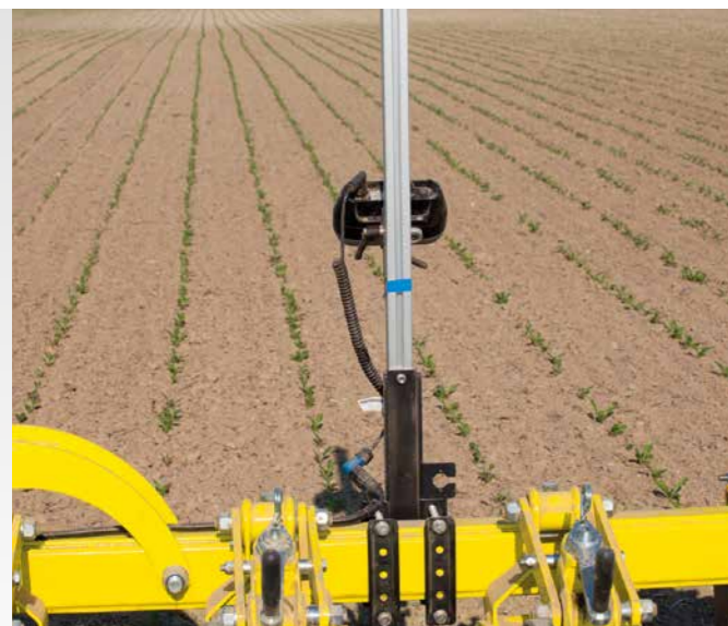
La hauteur et l'angle d'orientation de la caméra pourront être réglés en fonction du stade de croissance des plantes.
