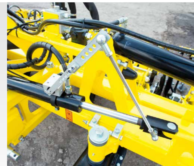
Capteur de la position actuelle du cadre de la machine par rapport à l'attelage 3 points.
