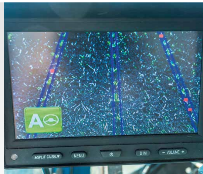
Le système de surveillance Culti Cam intègre également un moniteur 7" qui transmettra à l'opérateur toutes les informations relatives à la détection des plantes.
