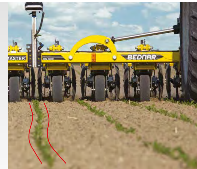
Le système d'autoguidage est capable de diriger la machine Row-Master même lorsque les plantes ont été semées en arc-de-cercle.
