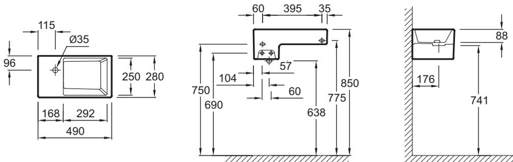
Description : Lave-mains. EGA012. Collection : TERRACE. Dimensions : 49 x 28 cm. Poids : 10 kg. Matériau : Céramique. Type d'installation : Autoportant ou peut être monté sur un meuble spécifique. Percement et pré-perçement robinetterie : Percé 1 trou. ROBINETTERIE CONSEILLÉE : Avec un débit inférieur à 6 l/min.
