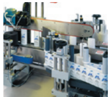
Stabilizzatore superiore MC15 Top stabilizer MC15 Contre-tapis supérieur MC15
