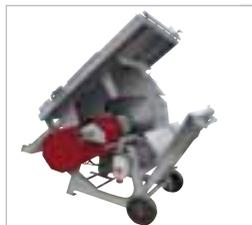
Scie circulaire WTK 710 EZ avec entrainement combiné. Prise de force et moteur électrique.
