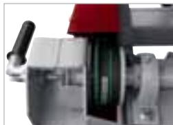
En conformité aux normes CE de sécurité, la machine est équipée d'un dispositif de déclenchement avec fonction de commutation pour interrompre la transmission de la force entre le tracteur et la lame de la scie circulaire et, en même temps, actionner le frein de la lame.
