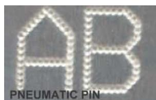
**PNEUMATIC PIN** – Le débattement de la pointe est généré pneumatiquement (en opposition au mode 'ELECTRIC PIN' qui n'a pas besoin d'alimentation en air). Recommandé pour le marquage sur des surfaces irrégulières.
