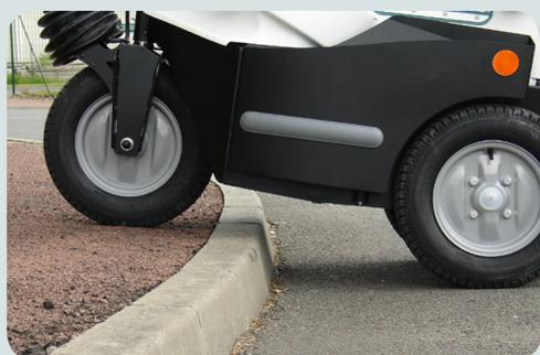
Franchissement des bordures et des pentes de 20 cm en montant et jusqu'à 22 cm en descendant. Pente admissible 30 %.
