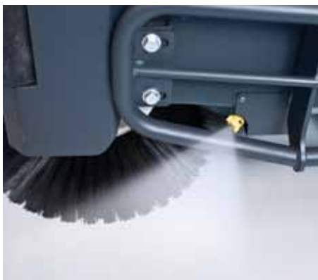
Système DustGuard™ pour limiter la poussière dans l'air générée par le balayage de brosse latérale jusqu'à 85 %
