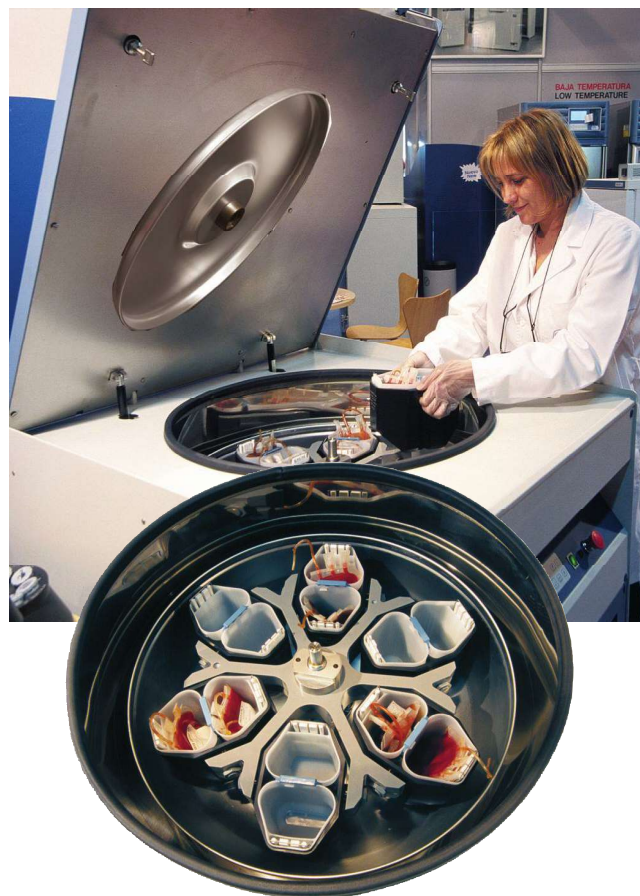
Image de la centrifugeuse avec rotor et pots à double compartiment pour poches de sang triples ou quadruples de 500 à 800 ml.
