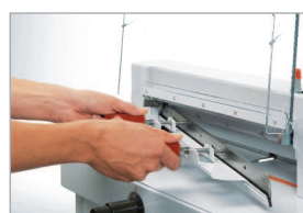
Dispositif de changement de lame protégeant le tranchant
