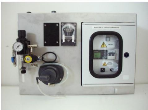
Filtration automatique de l'échantillon pour analyseur en ligne. Tamis de filtre en acier inoxydable et nettoyage automatique avec injection cyclique d'air du réseau d'usine. Liaison pour commande de démarrage par l'analyseur.
