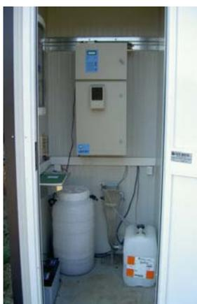
Les stations SysStat surveillent automatiquement un écoulement d'eau en combinant des sondes et analyseurs avec une centrale d'acquisition et une transmission des données et alarmes. Tamis de filtre en acier inoxydable et nettoyage automatique avec injection cyclique d'air du réseau d'usine. Liaison pour commande de démarrage par l'analyseur.
