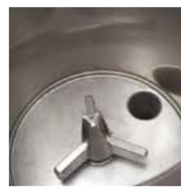
Vidange de l'eau résiduelle
