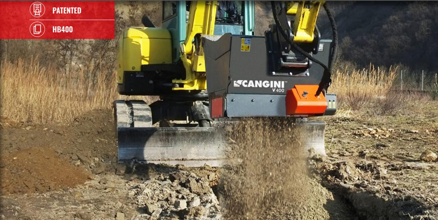
ADAPTÉ À LA SÉLECTION DE DÉCHETS DE TRAVAUX DE DÉMOLITION OU DE TERRASSEMENT ET AU MALAXAGE DE TERRE ET TOURBE. LE TRIAGE S'EFFECTUE GRÂCE AU CRIBLE HYDRAULIQUE DOTÉ DE COUTEAUX ROTATIFS EN HB400. EN CONFIGURATION STANDARD LA TAILLE DU MATÉRIAU PEUT ÊTRE COMPRISE ENTRE 0 ET 20 ET ENTRE 0 ET 35. LES DIMENSIONS DES ARBRES PEUVENT ÊTRE VARIÉES SELON LES EXIGENCES.
