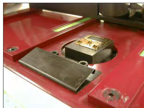
Mise en place de l'Enclume et de l'Attache. Les attaches n'ont qu'une position possible sur l'enclume.
