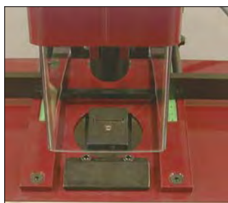
Mise en place de l'Enclume et de l'Attache. Les attaches n'ont qu'une position possible sur l'enclume.
