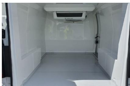
Plancher antidérapant avec caissons de passages de roues.
