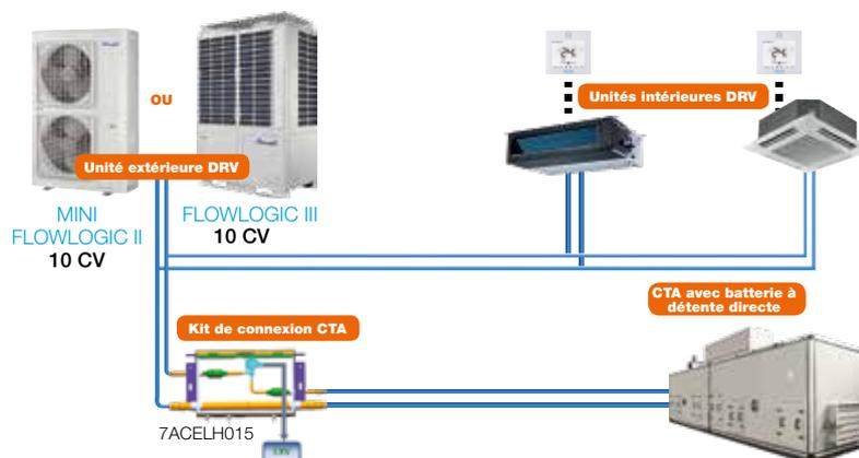
5 CV (14 kW) < Capacité de CTA connectée ≤ 10 CV (28 kW)
