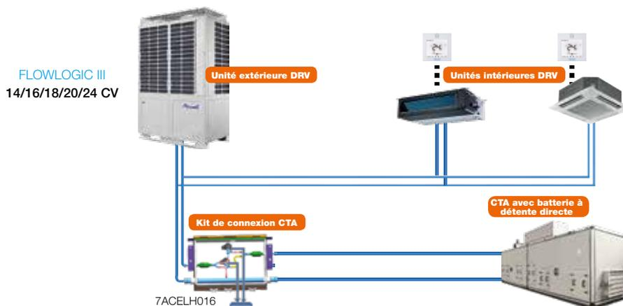
10 CV (28 kW) < Capacité de CTA connectée ≤ 20 CV (56 kW)
