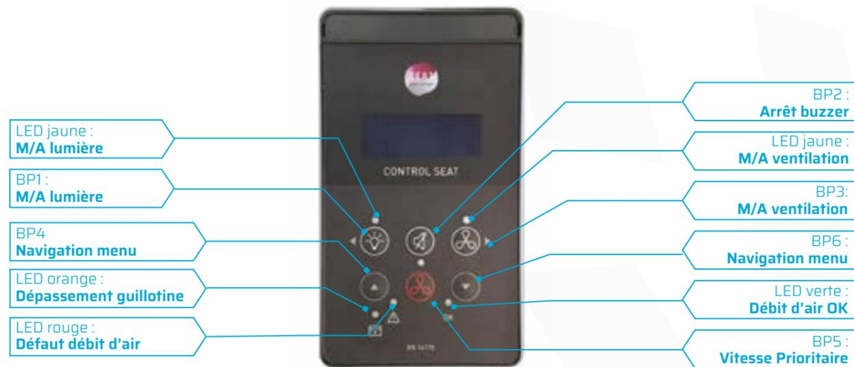
✓ Ce contrôleur est conforme à la norme EN 14175 et RoHS
