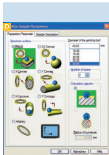
Mesure de l'épaisseur d'une couche : paramètres
