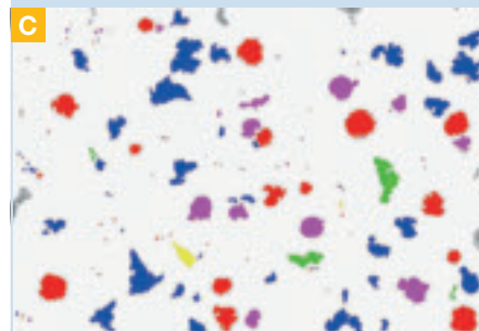
Analyse de la fonte à graphite sphéroïdal
