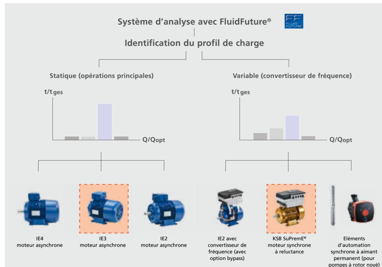
La technologie d'automatisation innovante du moteur SuPremE® de KSB est particulièrement adaptée aux profils de charge variables car le moteur SuPremE® atteint un niveau d'efficacité élevé dans les tranches de charges partielles. La version actuelle va même au-delà des spécificités requises par la régulation ErP 2017
