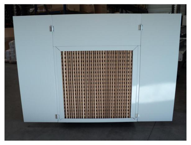
La cabine de peinture fabriquée par STIVENT INDUSTRIE est utilisée pour l'aspiration des pigments, produits par le pistolage de peinture, vernis, colle néoprène et autre substance liquide pendant son fonctionnement.
