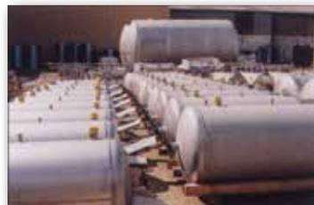
La résistance aux agressions chimiques, dues aux produits de traitement présents dans l'eau, est optimisée par le décapage et la passivation en bain de l'ensemble du réservoir, dans un atelier de décapage ultra moderne, répondant aux normes environnementales les plus sévères.
