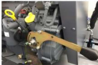
Réglage de la vitesse de rotation manuel
