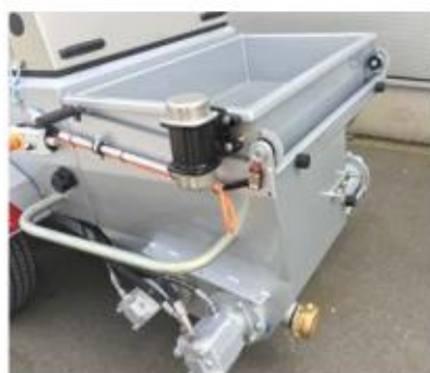
La cuve de malaxage avec un volume de 400 litres
