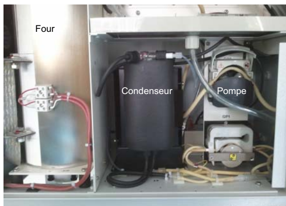
Four, condenseur à effet Peltier, têtes de pompe d'échantillon, acide et drains
