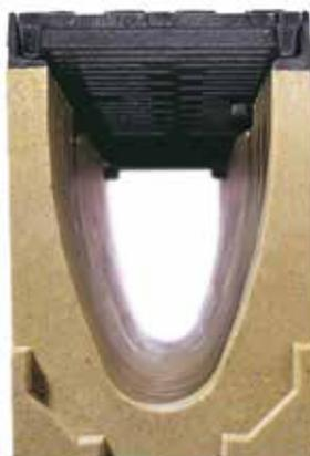
La zone inférieure plus étroite de la section transversale en forme de V permet des débits beaucoup plus élevés et garantit ainsi un effet d'auto-nettoyage optimal.
