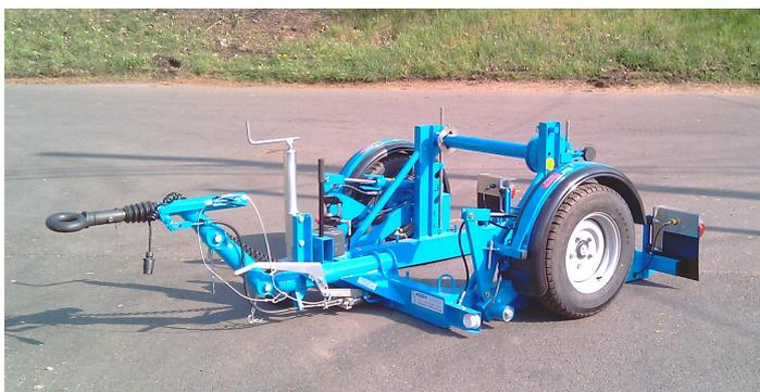
La remorque dérouleuse SIPREL RASSOL RT 900 est conçue pour le transport et le déroulage des tourets de câbles électriques et de fibre optique. Grâce au système breveté RASSOL, actionné par une pompe hydraulique manuelle, le châssis de la remorque s'abaisse au sol, il est alors facile et rapide de charger un touret. Une seule personne peut aisément faire cette opération. Il est possible d'actionner les vérins séparément pour faciliter le chargement et le déroulage d'un touret placé en dévers
