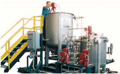
Skid d'Injection de Phosphate
