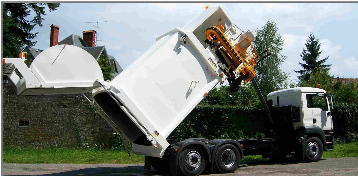
La hauteur du caisson en mode vidage est de 5750 mm dimension à laquelle il faut ajouter la hauteur du châssis porteur et la hauteur du système de pesée
