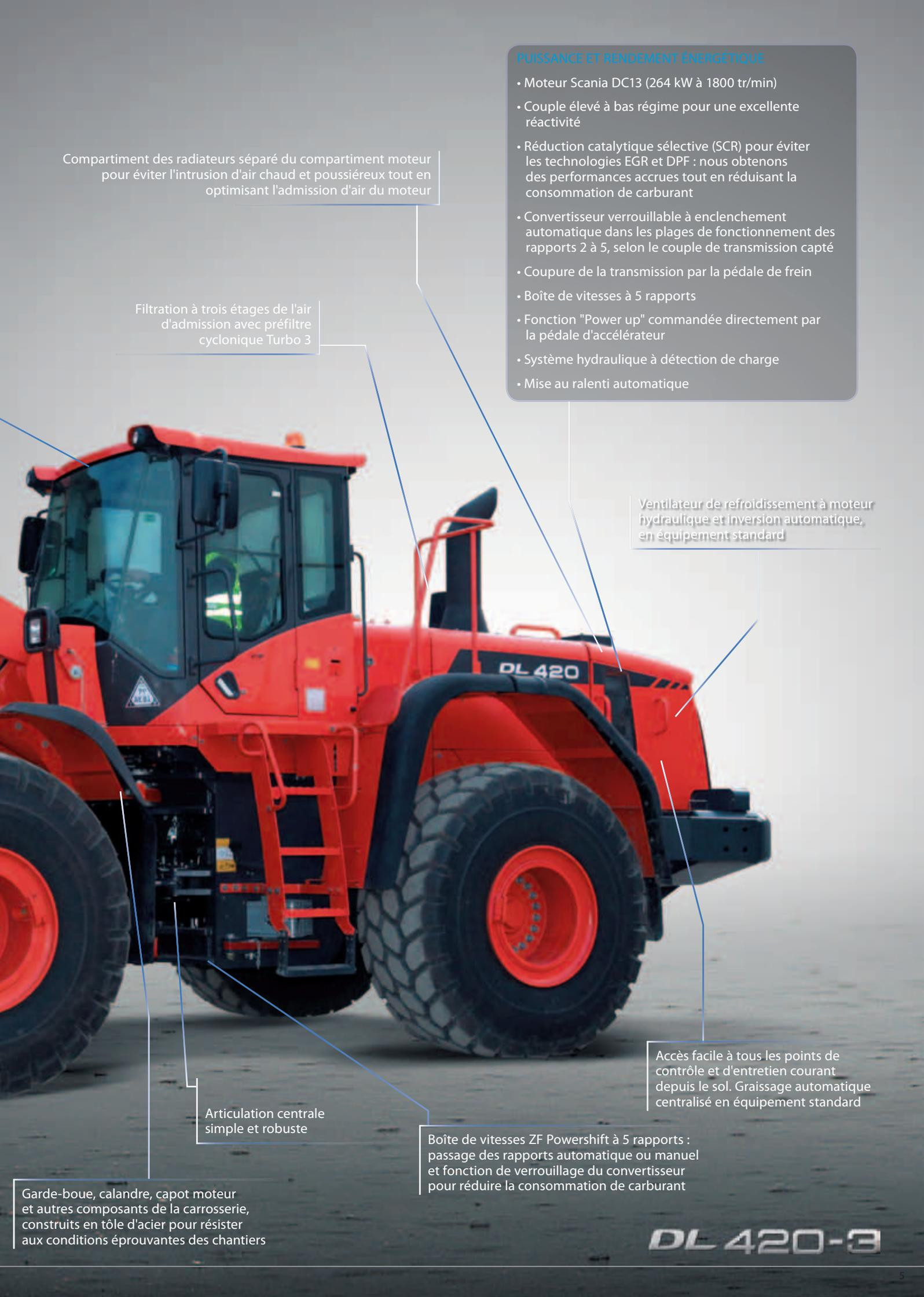
Compartiment des radiateurs séparé du compartiment moteur pour éviter l'intrusion d'air chaud et poussiéreux tout en optimisant l'admission d'air du moteur
