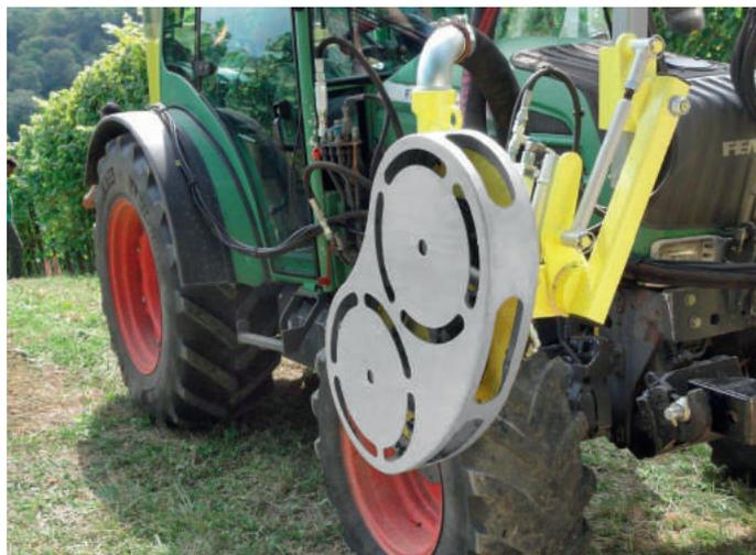
◀ **L'ELLIPSE-MULTIROTOR® COLLARD®** est compacte et d'un encombrement réduit pour se « glisser » dans la végétation. Son système de distribution d'air par joint tournant\* est ultra-performant et facilite l'orientation des têtes.
