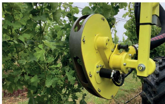
▲ Entraînement des rotors par moteurs hydrauliques drainés. Capteur de vitesse de rotation électronique intégré.
