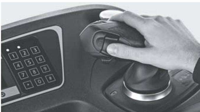
Joystick 4Plus en option (levée/descente et conduite d'une seule main sans changement de position)
