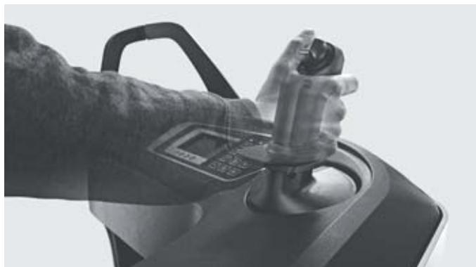
Enchaînement précis de mouvements de traction, de levée et descente sans changement de position grâce au joystick de série
