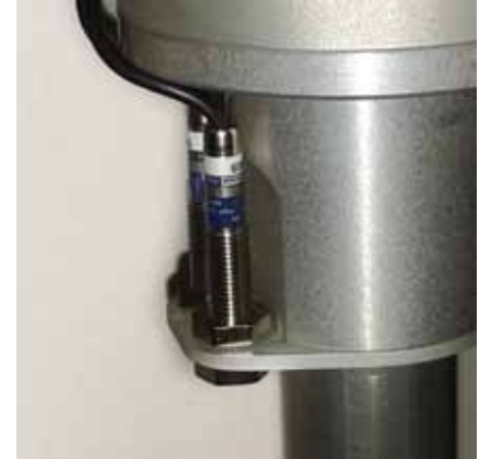
Présence main à capteur optique sur la gouverne.
