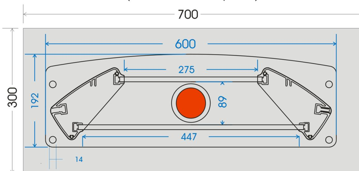
Massif béton dosé à 350 Kg/m<sup>3</sup>
