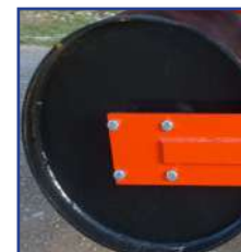
Cylindre en tôle ST52 de 12 mm
