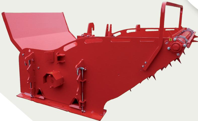
Châssis + long de 0,35m afin de distribuer dans les auges ou sur l'aire d'alimentation sans rouler sur le fourrage par la suite
