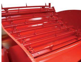
Tôle de fond sous le tapis d'entraînement du déroulage de la balle de fourrage
