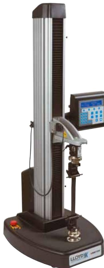
La LS5 est une machine d'essai des matériaux de haute précision permettant de réaliser des mesures de 0,0001 N jusqu'à 5 000 N. Elle offre une sécurité et une flexibilité unique grâce à son pupitre ou sa télécommande. Un port USB lui autorise une communication simple et rapide avec le logiciel d'essai NexygenPlus.
