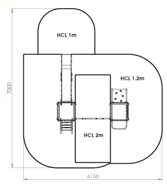
HCL 1m : 4.6 m<sup>2</sup> HCL 1.2m : 22.6 m<sup>2</sup> HCL 2m : 6 m<sup>2</sup>
