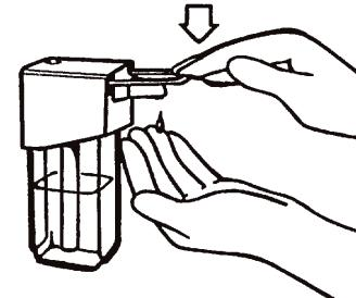
Bei der ersten Inbetriebnahme den Hebel einige Male bis zum Anschlag niederdrücken, bis der Spender dosiert. Dabei die Hand unter den Auslauf halten.
