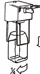
Der Behälter kann leicht herausgenommen werden, indem er 45° gedreht und nach unten herausgezogen wird.
