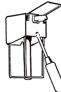
Werksmäßig ist der Spender auf eine Dosierung von ca. 1,5 ml/Hub eingestellt. Bei Bedarf kann sie stufenweise durch Drehen des Dosierstücks verringert werden.
