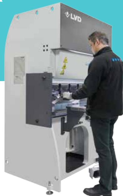
Les modèles standard 12/8 et 24/12 de la série Dyna-Press sont équipés d'une butée arrière à **2 axes** (X, R). Le modèle Dyna-Press 24/12-Plus a une butée arrière à **4 axes** (X, R, Z1, Z2).
