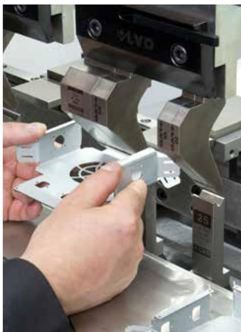
La presse plieuse Dyna-Press à **entraînement électrique** est actuellement disponible avec des forces de pliage de 12 et 24 tonnes et des longueurs de pliage de 835 et 1250 mm.
